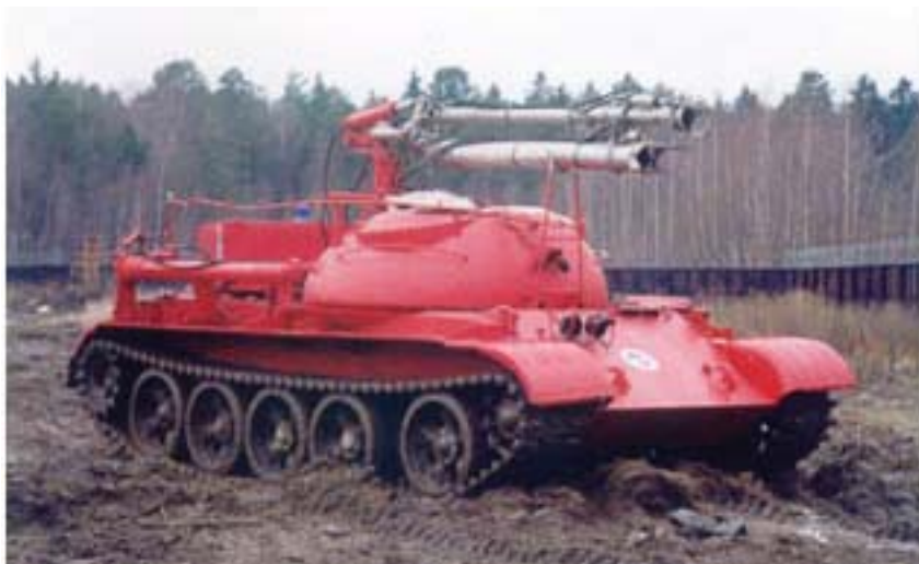
Рис. 3. Роботизированный самоходный пожарный лафетный ствол «Сойка»
