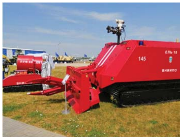
Рис. 5. Робототехнические комплексы «Луф-60» и «Ель-10»
