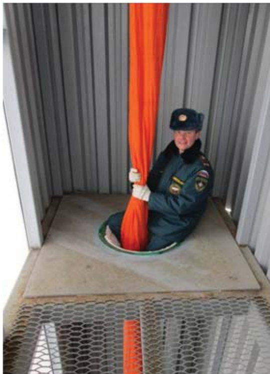
Рис. 5. Проведение натурных и приемочных испытаний спасательных рукавов системы аварийной эвакуации (САЭ) на космодроме Восточный
