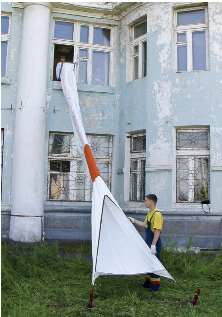
Рис. 6. Матерчатый трап «Трап-М»
