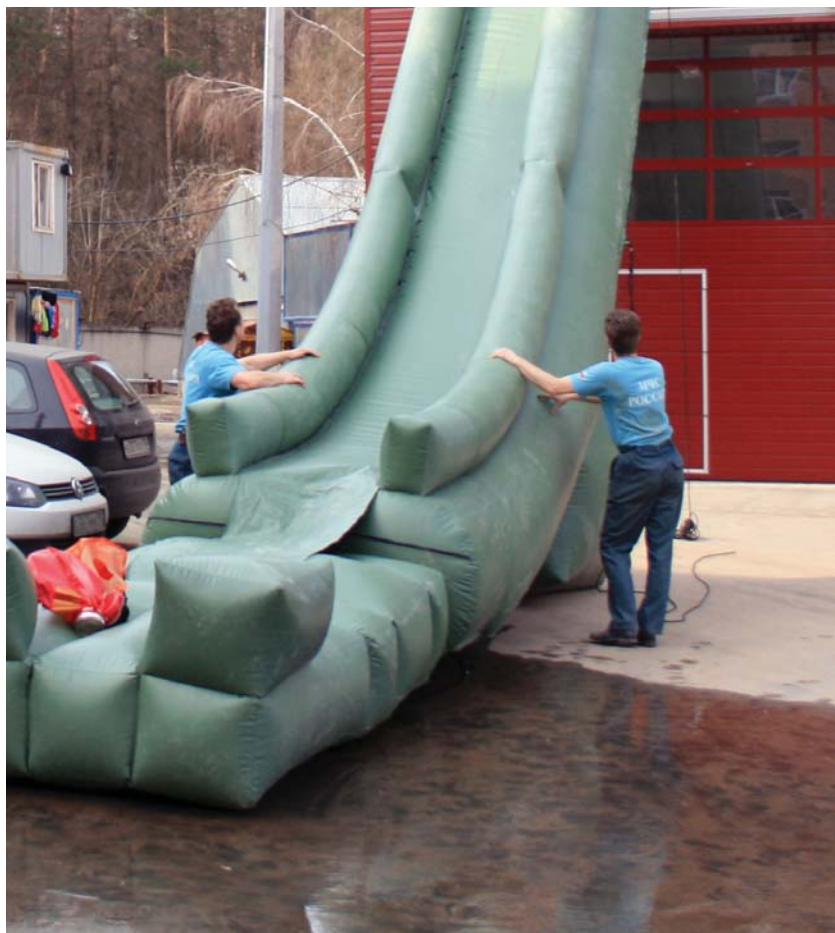
Рис. 7. Пневматический трап «Трап-П»
