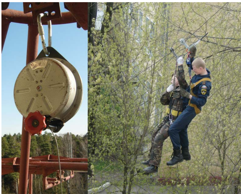
Рис. 5. «УГИ-1» и спуск по наклонному тросу
